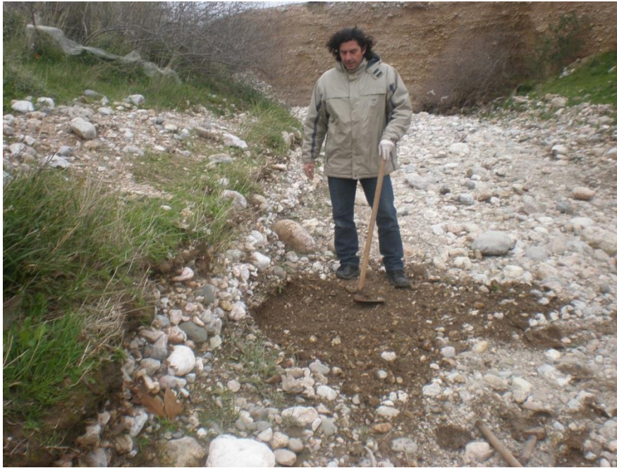
Εικόνα 6.13: Διευθέτηση της κοίτης της Γιαννούλας για την πραγματοποίηση υδρομετρήσεων.
