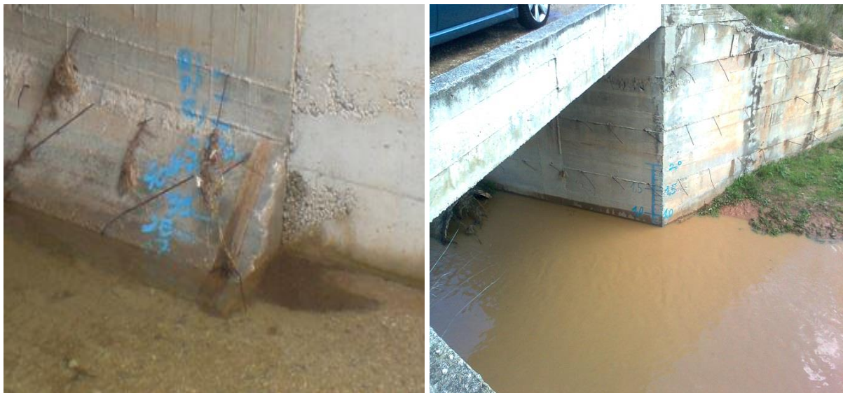
Εικόνα 6.15: Κατασκευή απλού σταθμήμετρου για την μέτρηση στάθμης στο ρ. Σαρανταπόταμου.
