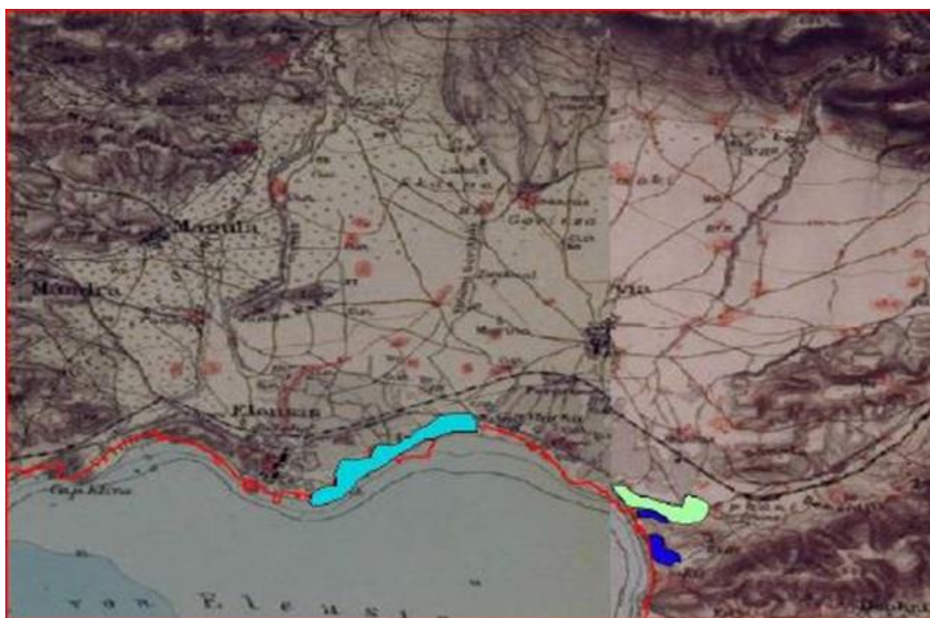
Εικόνα 7.10: Χάρτης του Kaupert όπως έχει επεξεργασθεί από τους Δασακλή κ.ά. (2009) δείχνει την εκφόρτιση με μορφή διαρροής προς τα πάνω του υπόγειου υδροφορέα διαμέσου των αλλουβίων με γαλάζιο χρώμα και με πράσινο τον βαλτότοπο.
