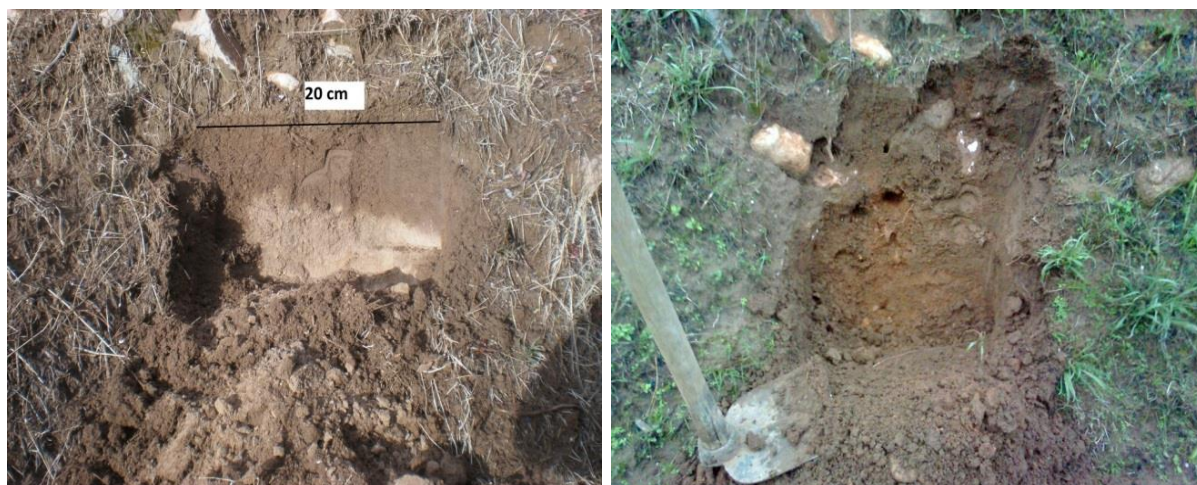
Εικόνα 6.22: Διήθηση στην λεκάνη του ρ. Σαρανταπόταμου α) σε βάθος 0,1 m στις 6-11-2013 και β) 0,25 m στις 2-12-2013.
