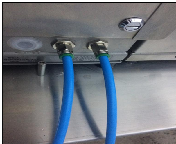
Εικόνα 17: Παροχή και έξοδος νερού ως ψυκτικό μέσο Πηγή: Προσωπική συλλογή
