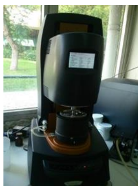
Εικόνα 3.3. Γεωμετρία ομόκεντρων κυλίνδρων
