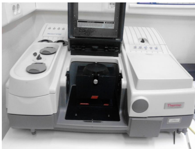
Εικόνα 17: Φασματόμετρο Υπερύθρου FT-IR, Nicolet 6700
