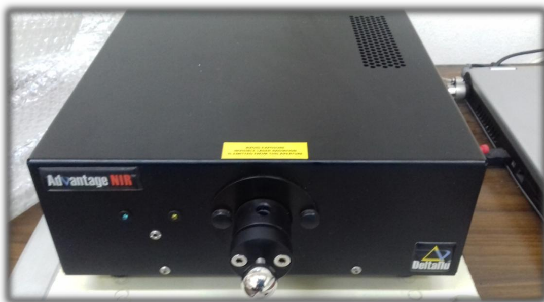
Εικόνα 21: Φασματόμετρο Raman (FT-Raman), Advantage NIR, DeltaNu
