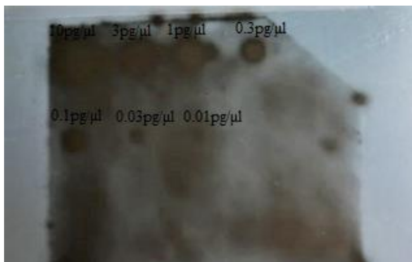
Εικόνα 2.8: Φίλμ μετά από έκθεση 30min με ενισχυμένο ανιχνευτή σε αραιώσεις 10pg/μl, 3pg/μl, 1pg/μl, 0,3pg/μl, 0,1pg/μl, 0,03pg/μl και 0,01pg/μl (1μl/κηλίδα).
