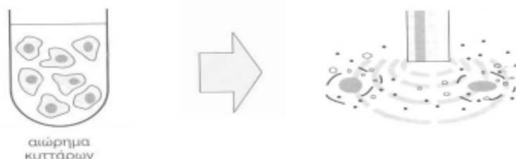
Εικόνα 16: Μηχανική λύση κυττάρων με υπερήχους (Χουρζαμανογλου, 2008).
