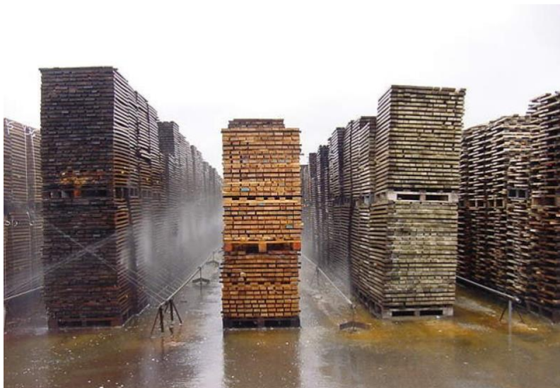
Εικόνα 7: Δούγιες κατά την διαδικασία της διαβροχής σε εξωτερικό χώρο, για την κατασκευή βαρελιών (Κοτσερίδης Γ., 2014).
