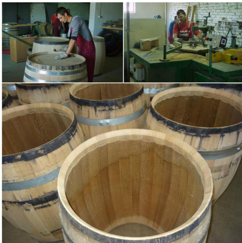
Εικόνα 11: Κόψιμο και ακριβής εφαρμογή της κεφαλής του βαρελιού στη εσοχή που σχηματίστηκε ( http://www.mastergardenproducts.com/howbarrelsmade.htm ).
