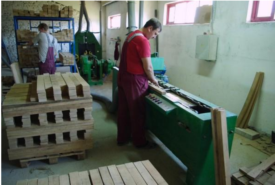
Εικόνα 6: Διαχωρισμός, λείανση και τοποθέτηση ξύλων από δρυ (δούγιες) πριν την διαβροχή τους στη βαρελοποιία ( http://www.mastergardenproducts.com/howbarrelsmade.htm ).
