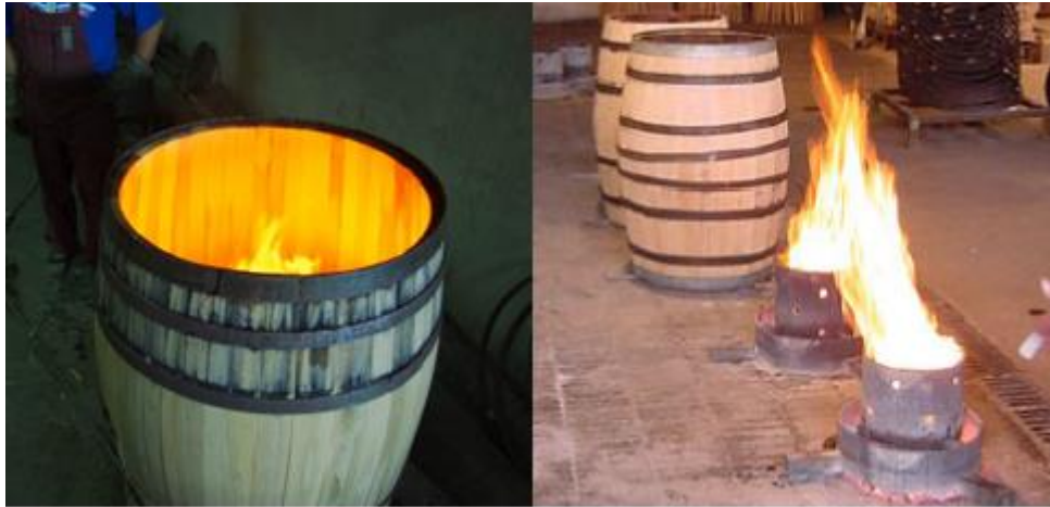
Εικόνα 9: Διαδικασία θέρμανσης/καψίματος του βαρελιού με στόχο να αποκτήσει την τελική του μορφή, και διαμόρφωση βαθμού καψίματος (Κοτσερίδης Γ., 2014; http://www.mastergardenproducts.com/howbarrelsmade.htm ).
