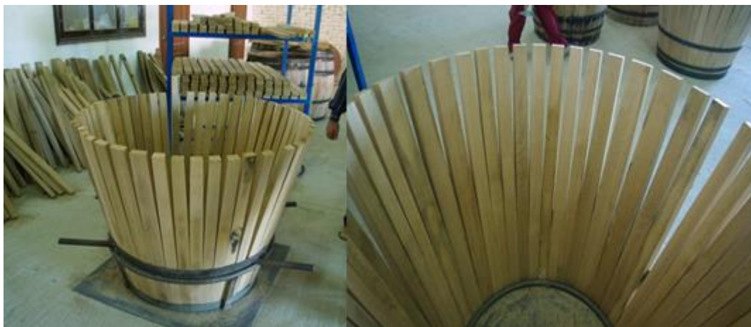
Εικόνα 8: Αρχή συναρμολόγησης βαρελιού με τοποθέτηση των ξύλων σε μεταλλικό στεφάνι (σχήμα τριαντάφυλλου) ( http://www.mastergardenproducts.com/howbarrelsmade.htm ).
