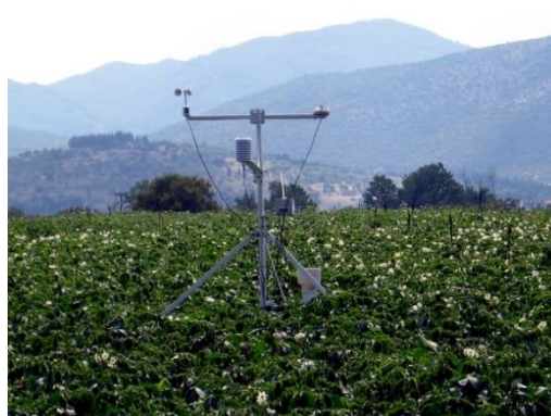
Εικόνα 2. 4 . Αυτόματος μετεωρολογικός σταθμός Γ.Π.Α. (AUA) εγκατεστημένος σε υπόβαθρο με χαμηλή πράσινη βλάστηση και με πλήρη επάρκεια εδαφικής υγρασίας, σε όλη την διάρκεια της καλλιεργητικής περιόδου. (Αλεξανδρής κ.α., 2013)
