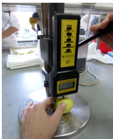
Εικόνα 20: Μέτρηση συνεκτικότητας φλοιού με το πενετρόμετρο CHATILLONDF1S 50
