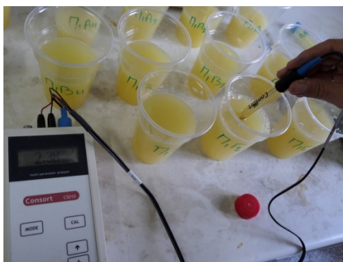
Εικόνα 22: Μέτρηση οξύτητας χυμού με το ψηφιακό pH-μετρο CONSORT C-5010
