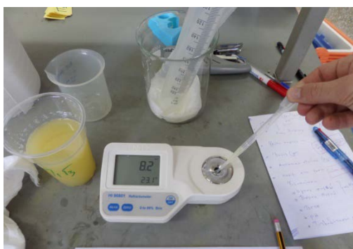
Εικόνα 21: Μέτρηση ολικών διαλυτών στερεών χυμού (°Brix) με ψηφιακό διαθλασίμετρο
