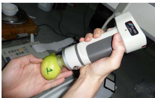
Εικόνα 19: Μέτρηση χρώματος φλοιού με τη συσκευή Minolta CR-300
