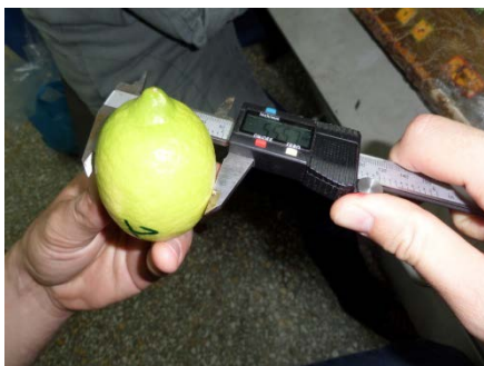
Εικόνα 17: Μέτρηση διαμέτρου καρπού με ψηφιακό παχύμετρο ακριβείας
