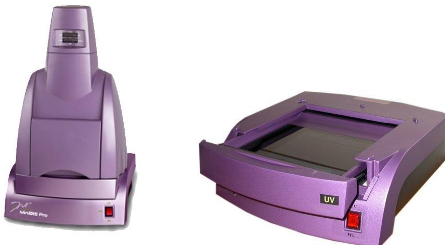
Εικόνα 2.10. Η φωτογραφική συσκευή MiniBis Pro της DNR Bio-Imaging Systems με το εξάρτημα της τράπεζας UV.
