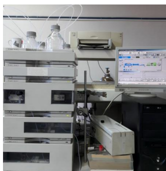
Εικόνα 22: Υγρός χρωματογράφος Agilent Technologies HPLC 1100, εφοδιασμένος με ανιχνευτή συστοιχίας διόδων (DAD)
