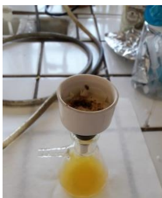
Εικόνα 18: Διήθηση υπό κενό σε χωνί Buchner
