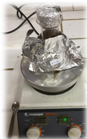
Εικόνα 32: Εκχύλιση στεμφύλων σε μαγνητικό αναδευτήρα.
