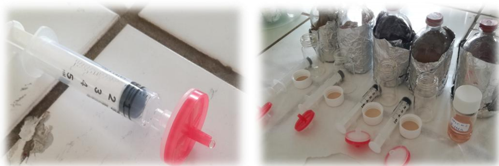
Εικόνα 35: Καθαρισμός εκχυλισμάτων πριν την ανάλυση με φιλτράκια Chromafil Xtra CA-45/25.
