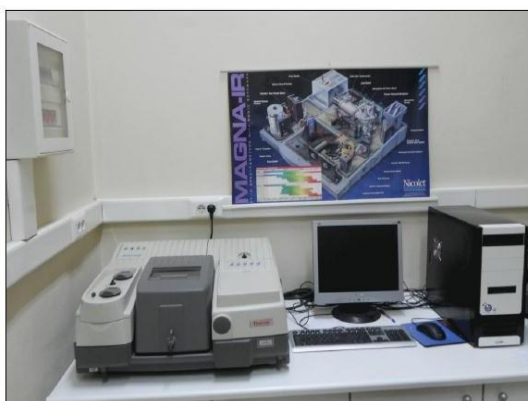
Εικόνα 43: Το φασματοφωτόμετρο FT-IR που χρησιμοποιήθηκε στις αναλύσεις.
