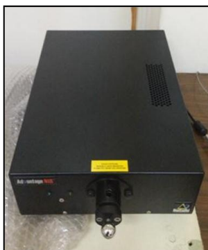
Εικόνα 46: Το φασματοφωτόμετρο Raman που χρησιμοποιήθηκε.
