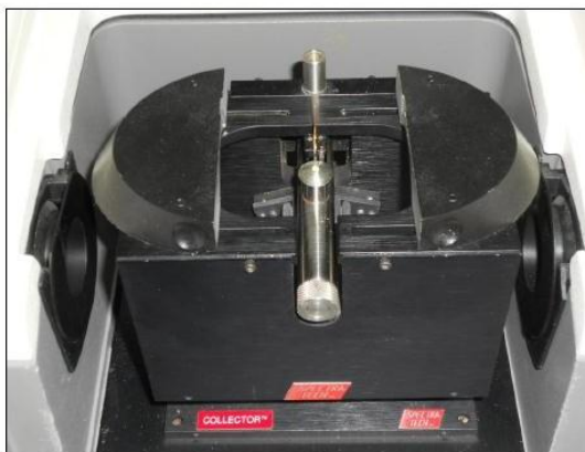
Εικόνα 44: Υποδοχέας δείγματος που φέρει καψίδιο.
