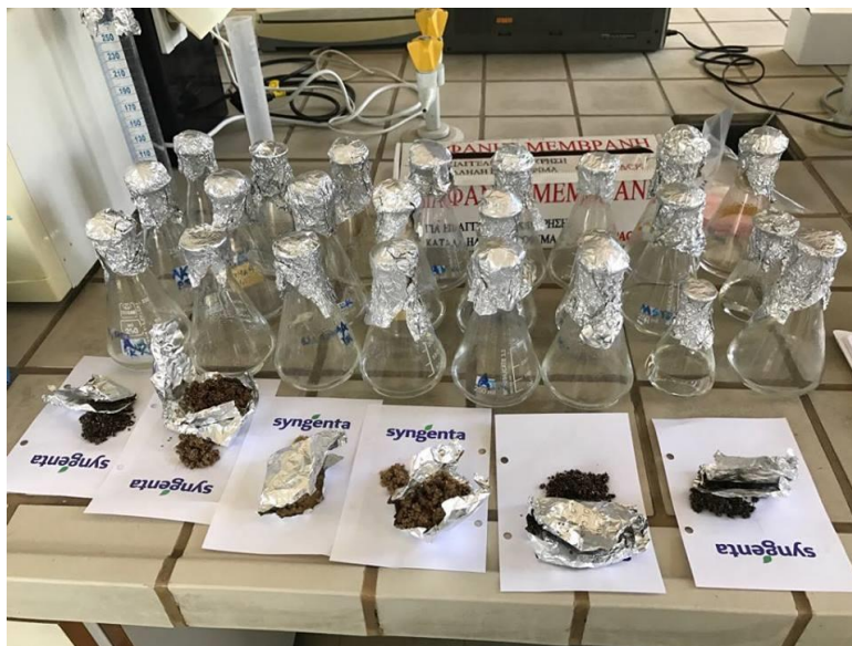
Εικόνα13. Προετοιμασία διαδοχικών αραιώσεων για την ανίχνευση της συγκέντρωσης του βιολογικού παράγοντα στα 6 υποστρώματα.
