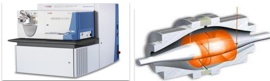
Εικόνα 27 A & B. Α) Αναλυτής Orbitrap http://planetorbitrap.com Β) Παγίδα ιόντων Orbitrap (Πηγή: http://departments.agri.huji.ac.il/zabam/orbitrap.html )
