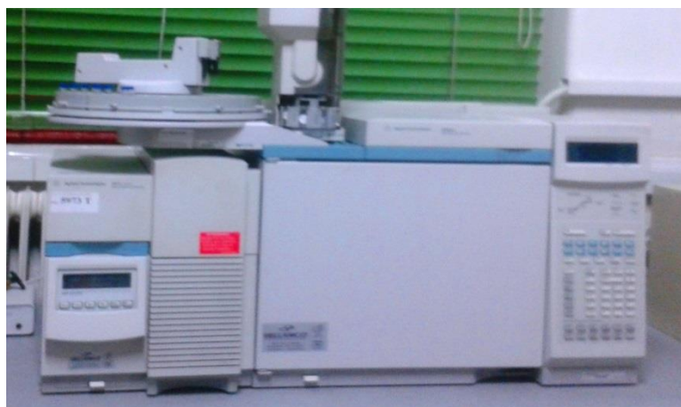
Εικόνα 43. Αέριος χρωματογράφος Agilent 6890N με ανιχνευτή μάζας MS 5973 inert mass selective detector (MSD)
