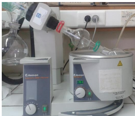
Εικόνα 3: περιστροφικός συμπυκνωτήρας υπό κενό
