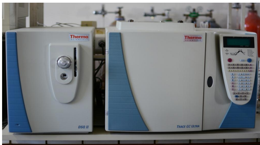
Εικόνα 23. Το σύστημα αέριας χρωματογραφίας-φασματομετρίας μαζών (GC-MS) που χρησιμοποιήθηκε.
