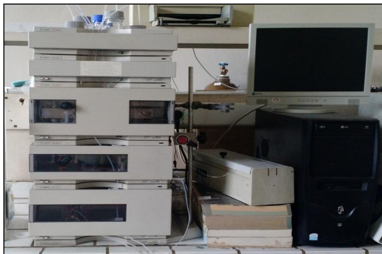
Εικόνα 41: Σύστημα υγρής χρωματογραφίας υψηλής πίεσης (HPLC) που χρησιμοποιήθηκε για τις αναλύσεις.
