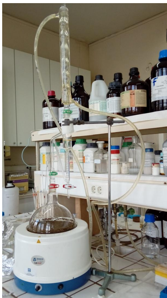
Εικόνα 2.4 Απόσταξη του φυτού Satureja hellenica για την παραλαβή αιθέριου ελαίου σε συσκευή Clevenger
