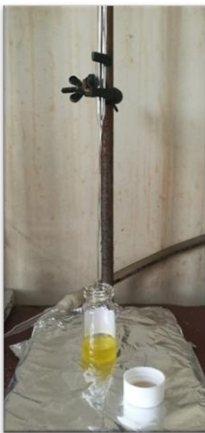
Εικόνα 2.6 Σύμπυκνωση επί ξηρού στο αέριο άζωτο
