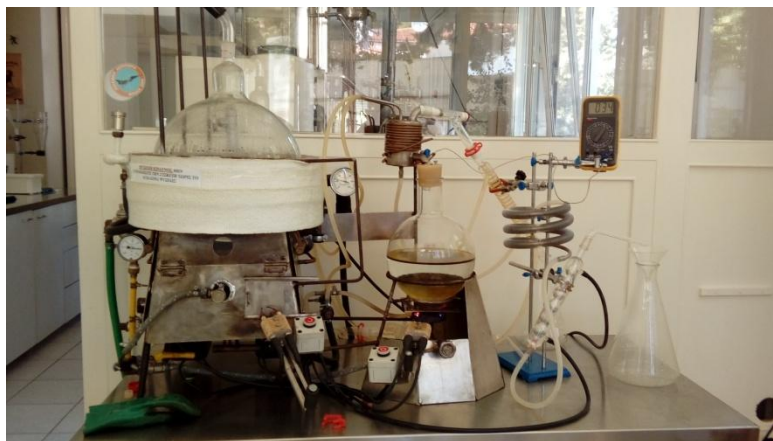
Εικόνα 2.5 Συσκευή Clevenger για την παραλαβή πτητικού τμήματος και υρολύματος από το έλαιο του φυτού N. sativa
