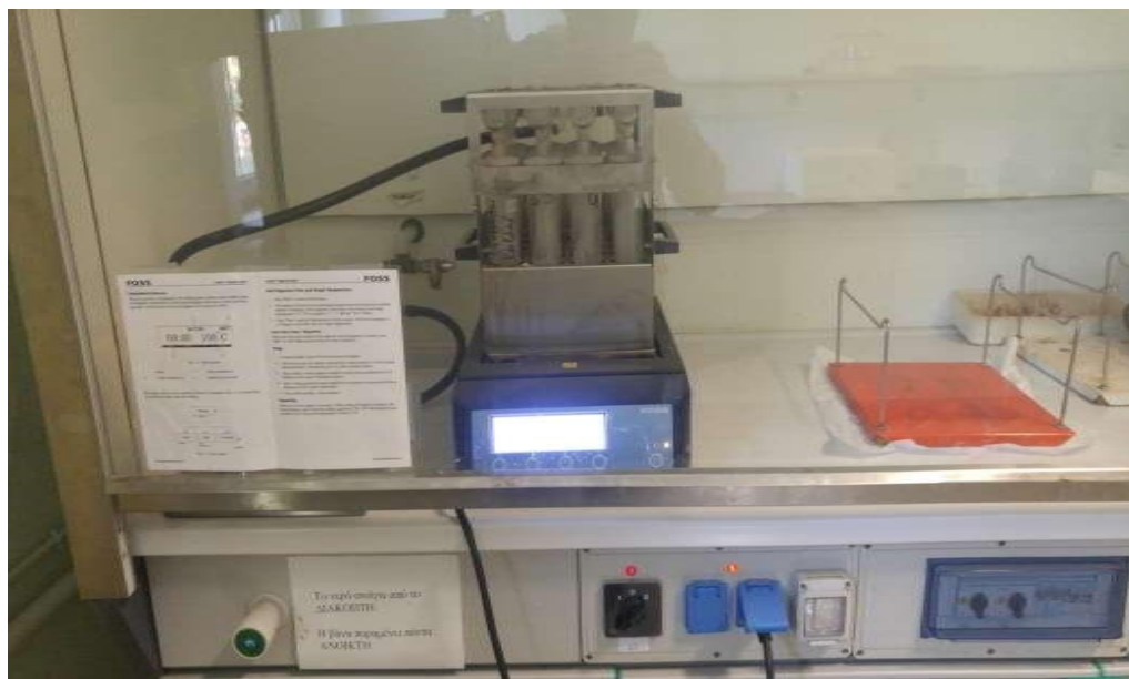
Εικόνα Π33: Κάψιμο για τη μέτρηση συνολικής πρωτεΐνης στο DT 220 Digester της FOSS, σπόρου με τη μέθοδο kjeldahl
