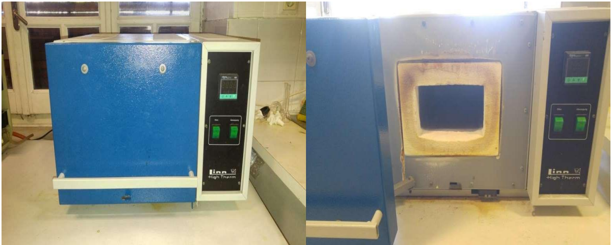
Εικόνα Π25 Πυραντήριο LM-312 της εταιρίας Linn High Therm
