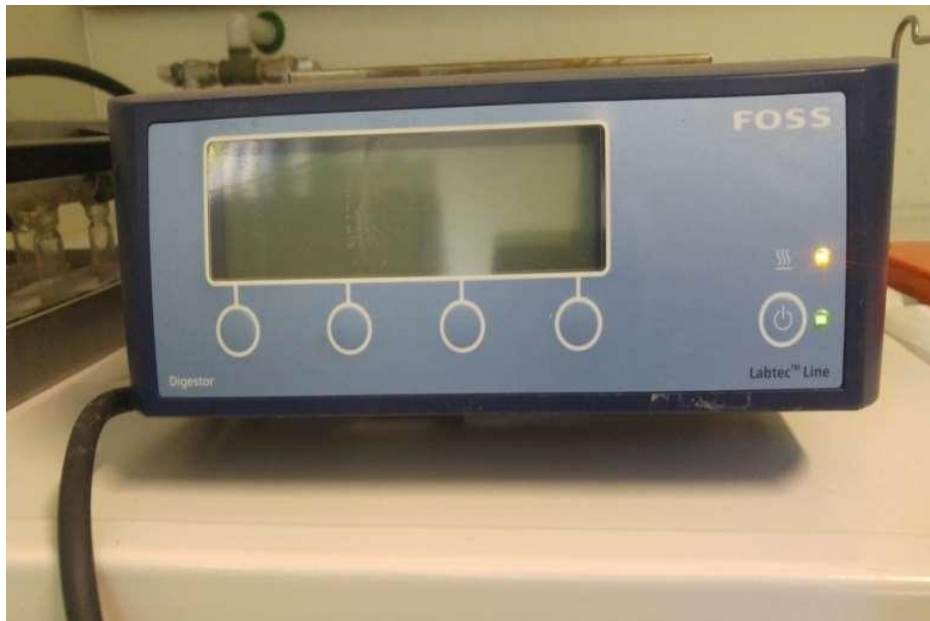
Εικόνα Π33: Κάψιμο για τη μέτρηση συνολικής πρωτεΐνης στο DT 220 Digester της FOSS, σπόρου με τη μέθοδο kjeldahl
