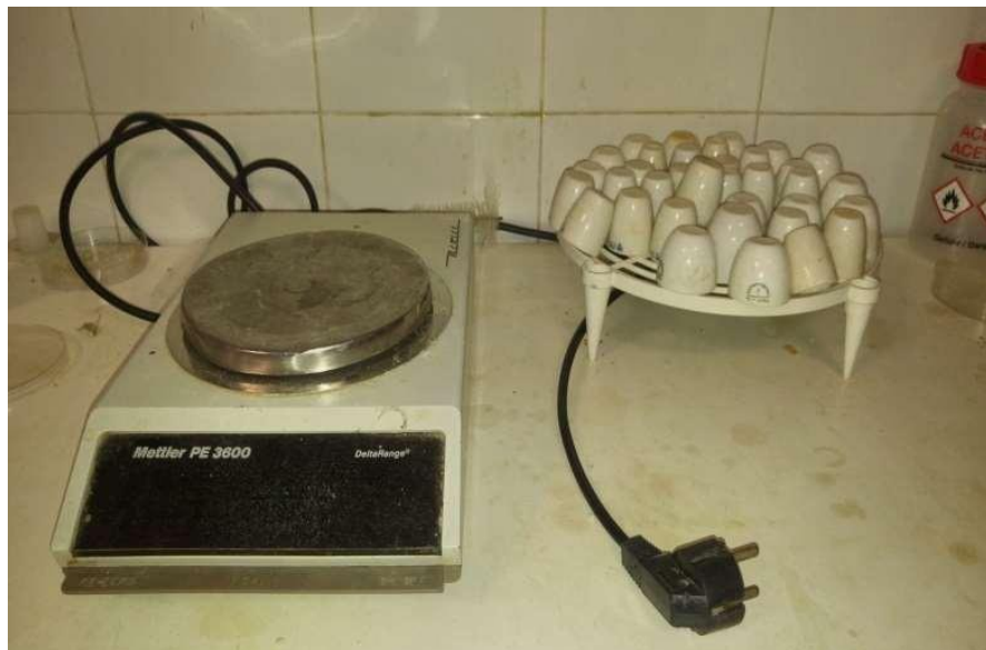
Εικόνα Π24: Ζυγαριά ακριβείας Mettler PE3600 δύο δεκαδικών, χρησιμοποιήθηκε σε όλες τις μετρήσεις από τη συγκομιδή έως το τέλος
