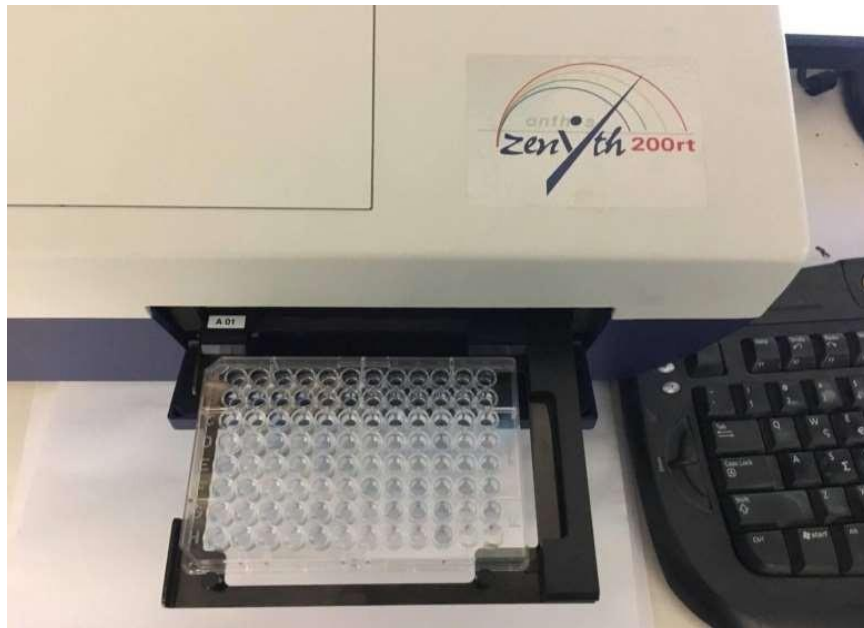
Εικόνα Π31: Φασματοφωτόμετρο Anthos zenyth 200rt της εταιρίας Biochrom για τη μέτρηση απορρόφησης Ολικού Φωσφόρου (P)
