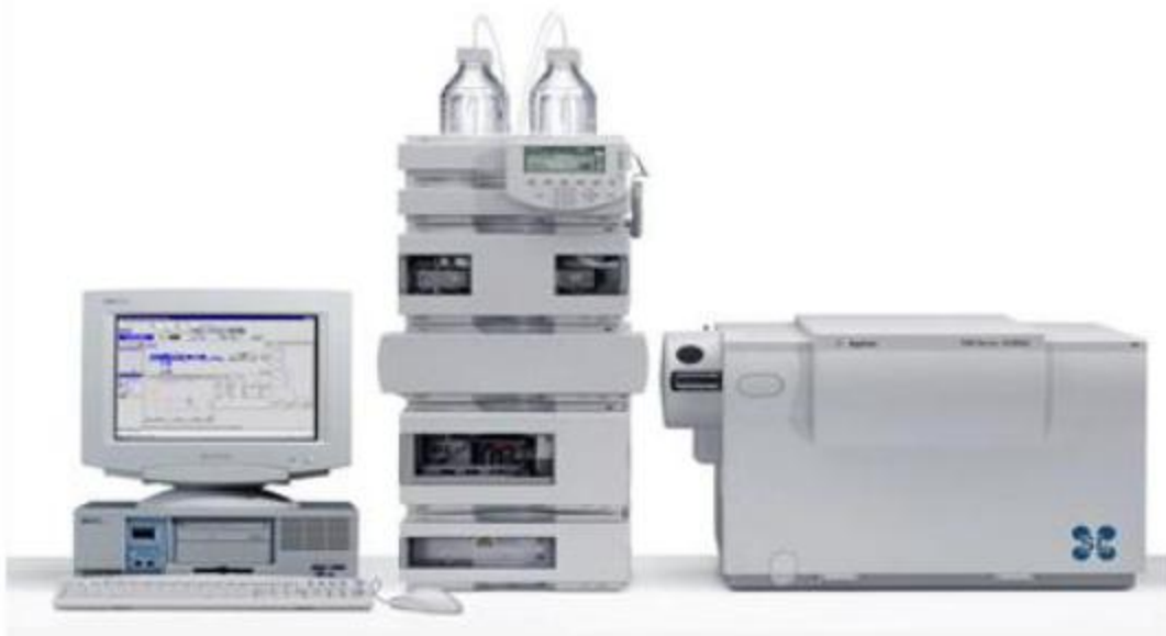
Εικόνα 1.13 Σύστημα φασματομετρίας απλού τετραπόλου σε συνδυασμό με υγρή (Agilent) (κάτω) και με αέρια χρωματογραφία (πάνω).
