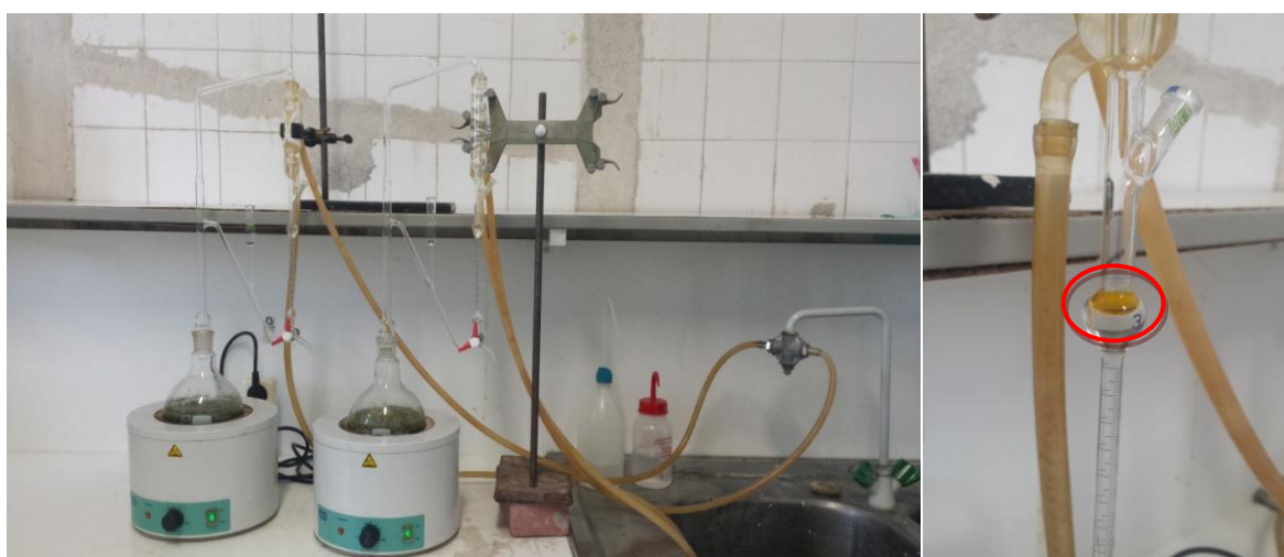
Εικόνα 2.8 Συσκευές Clevenger κατά την απόσταξη (αριστερά), συγκέντρωση αιθέριου ελαίου στο σωλήνα του κύριου μέρους της συσκευής πάνω από το υδατικό εκχύλισμα (αριστερά)
