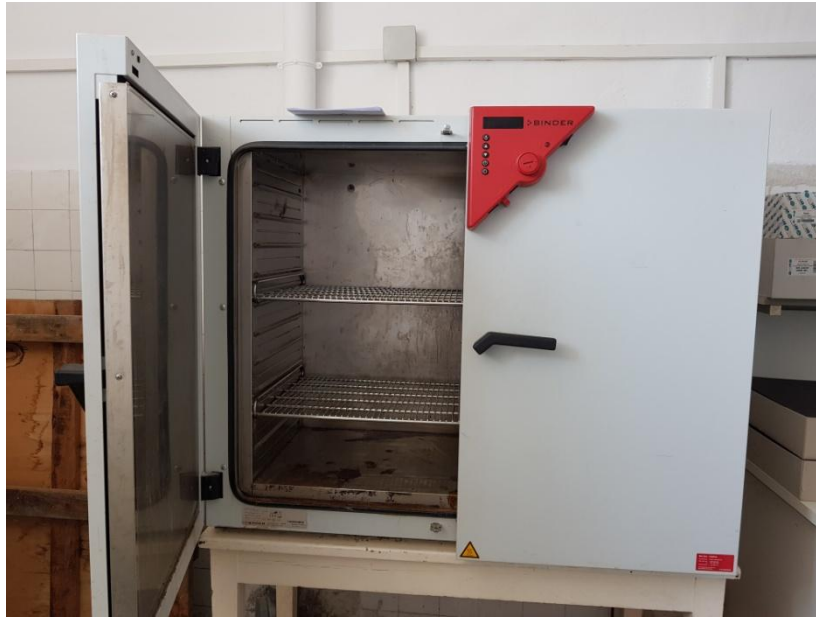
Εικόνα 2.6 Φούρνος BINDER - ED 400 για την αποξήρανση των δειγμάτων
