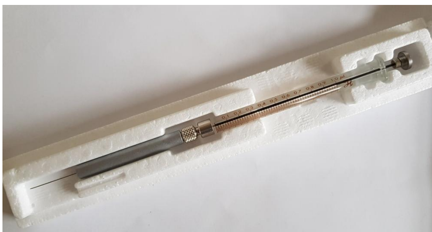
Εικόνα 2.11 Ένεση εισαγωγής δείγματος στο GC-MS για ανάλυση
