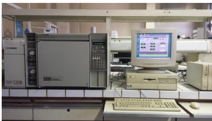
Εικόνα 2.10 Συσκευή GC-MS στο Εργαστήριο Χημείας του Γ.Π.Α.
