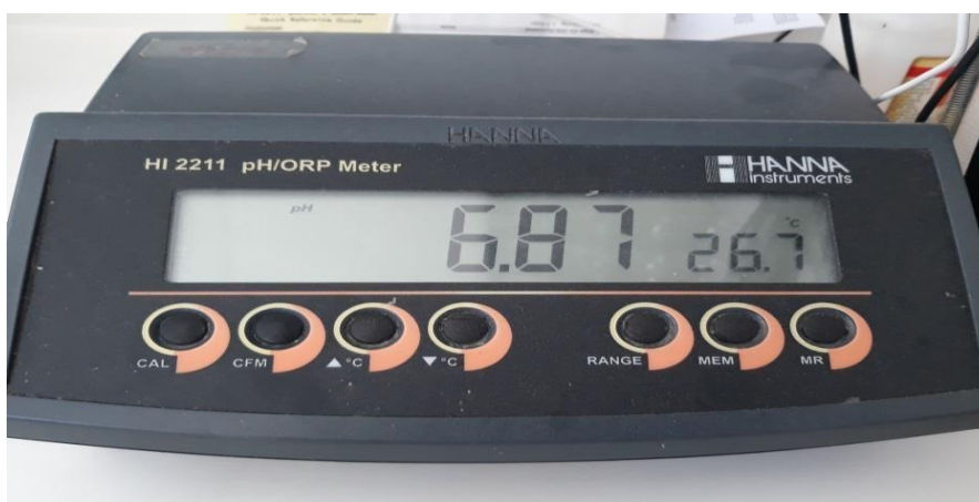
Σχήμα 8. Ηλεκτρονικό pH-μετρο HI 2211.
