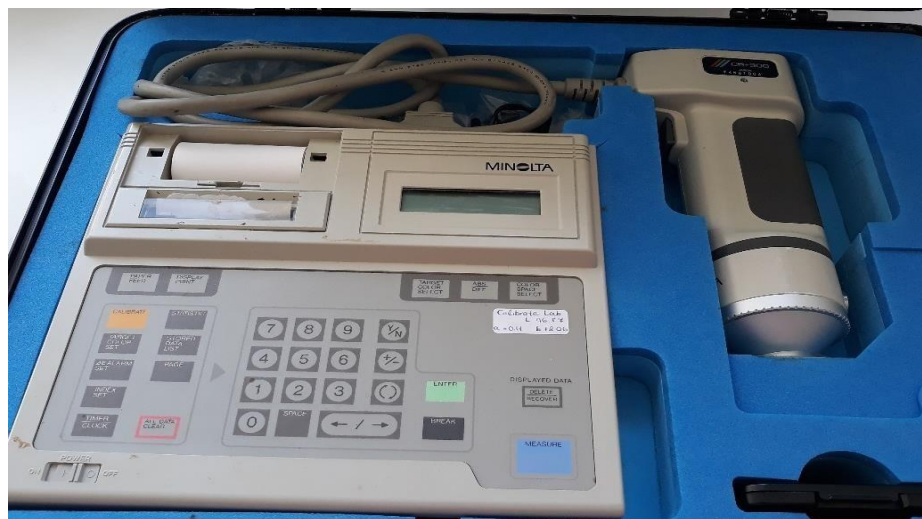
Σχήμα13. Χρωματομέτρο Minolta CR-300.
