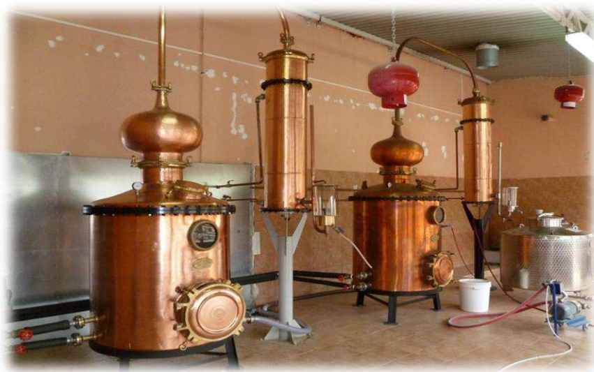
Εικόνα 1. Αποσταγματοποιείο – Άμβυκας & Στήλη
