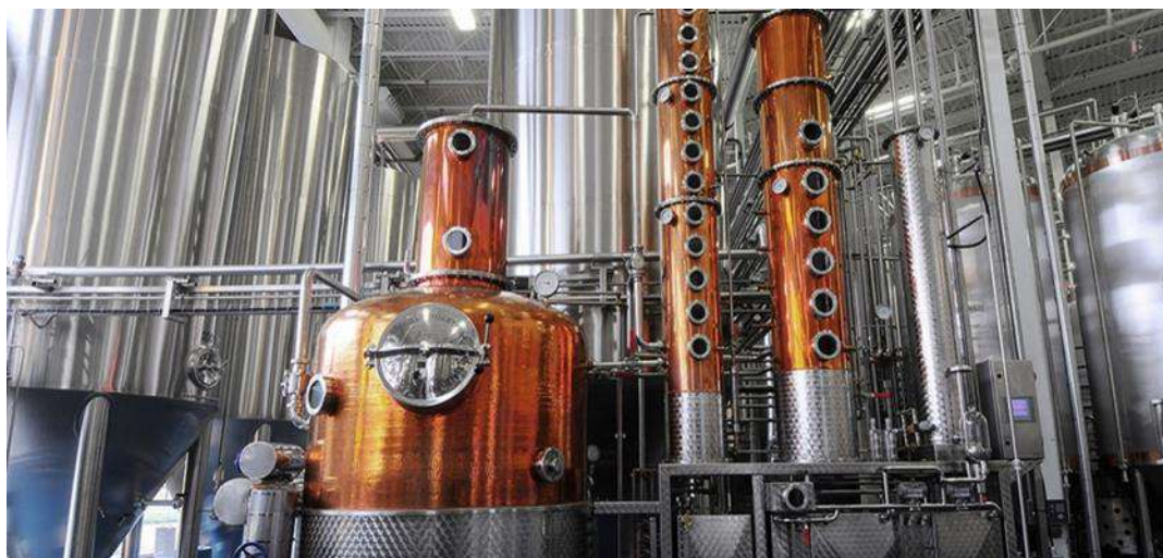
Εικόνα 13. Αποστακτήρας (Άμβυκας) κατασκευασμένος από καθαρό χαλκό
