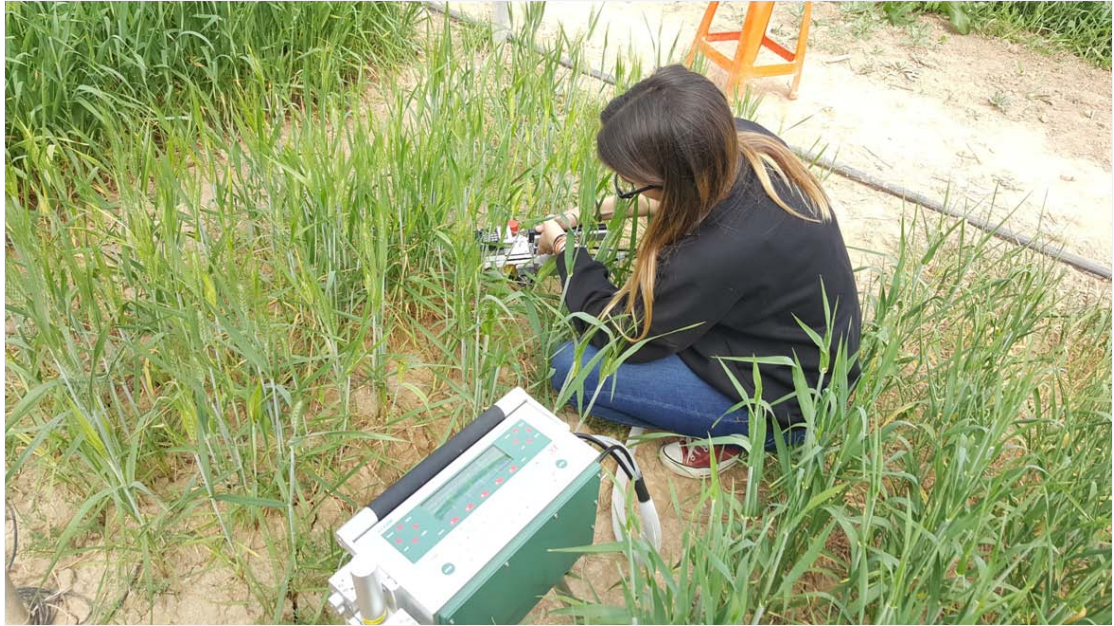
Εικόνα 2.3.3: Μέτρηση των παραμέτρων της φωτοσύνθεσης με την κινητή συσκευή Li-Cor 6400
