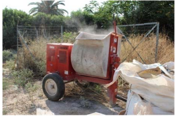
Εικόνα 70: Η ανάδευση των υλικών εν ξηρώ για την κατασκευή του κονιάματος ΜΤ σε μπετονιέρα
