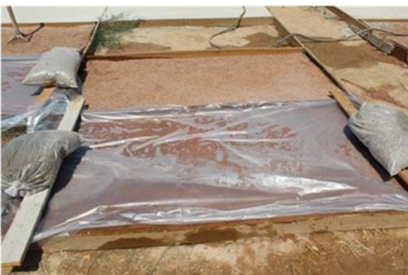
Εικόνα 79: Κάλυψη των δοκιμών μετά τη χύτευση με πλαστικό για την αποτροπή απότομης απώλειας υγρασίας
