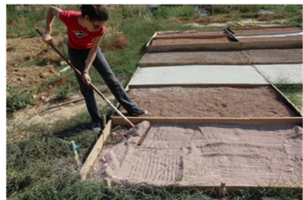
Εικόνα 74: Ομοιόμορφη κατανομή του ξηρού μίγματος για το κονίαμα ΜΤ στα καλούπια και ισοπέδωση
