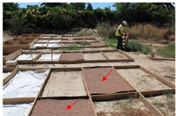
Εικόνα 80: Δοκίμια με γεωϋφασμα και ψηφίδα μετά την κατασκευή
