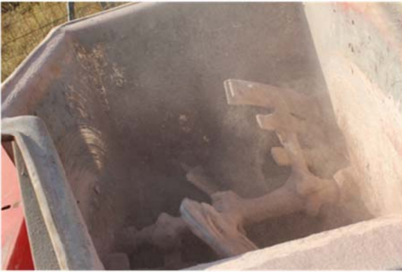
Εικόνα 71: Η ανάδευση των υλικών εν ξηρώ για την κατασκευή του κονιάματος ΜΤ σε μπετονιέρα
