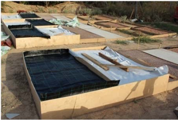
Εικόνα 58: Η δεύτερη στρώση γεωφάσματος διακρίνονται οι δύο τύποι, άσπρο: μη υφαντό, μαύρο: υφαντό
