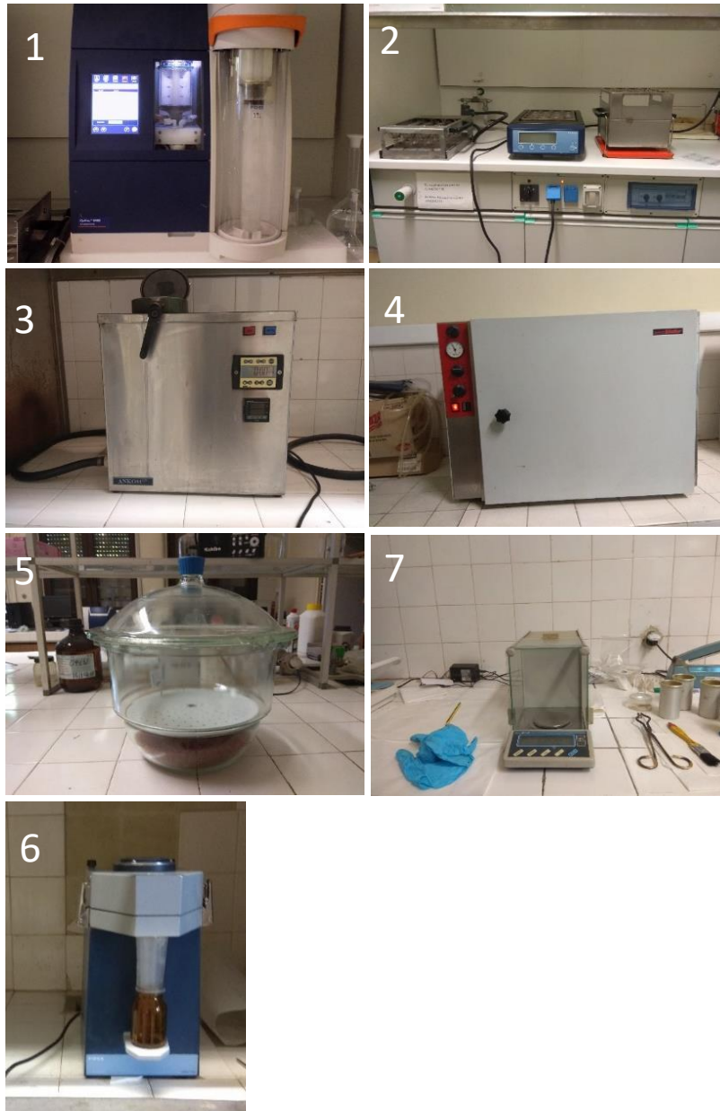
Εικόνα 2.6. (1) Μηχάνημα απόσταξης Kjeldahl, (2) Μηχάνημα για προσομοίωση χώνευσης (Digestor) στους 420° C για τρία τέταρτα της ώρας, (3) Μηχάνημα χώνευσης για τα κλάσματα ινωδών ουσιών (ANKOM Technology), (4) Κλίβανος για ξήρανση των δειγμάτων στους 103° C για έως 8 ώρες, (5) Ξηραντήρας, (6) Εργαστηριακός μύλος άλεσης, (7) Ζυγαριά ακριβείας τριών δεκαδικών ψηφίων.
