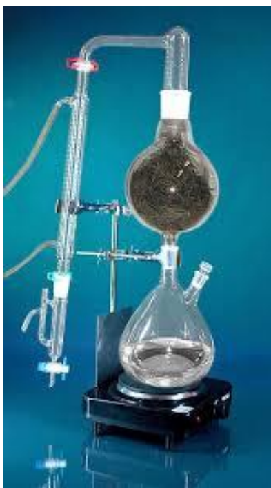
Εικόνα 2: Στην εικόνα αυτή, απεικονίζεται μία συσκευή Clevenger που είναι απαραίτητη στην περίπτωση της υδρο-απόσταξης.
