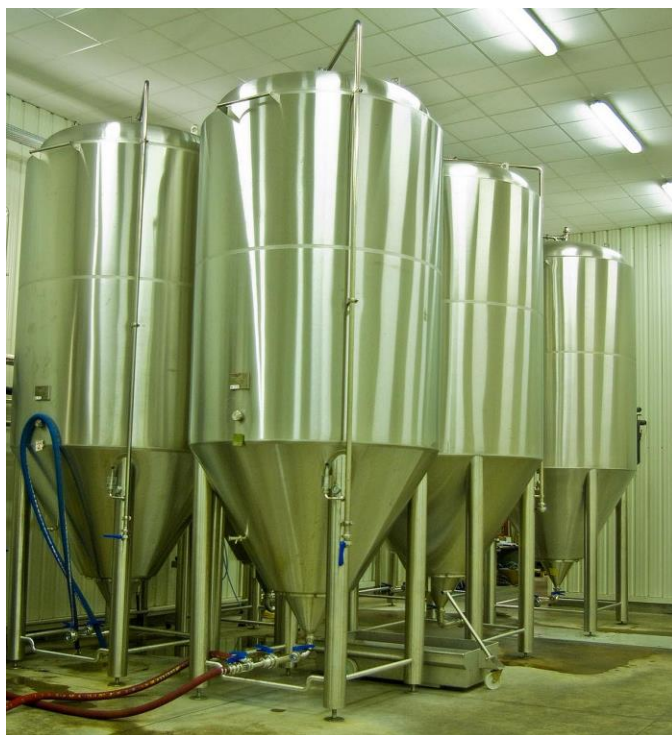
Εικόνα 1.3 Κυλινδρικές δεξαμενές ζύμωσης
