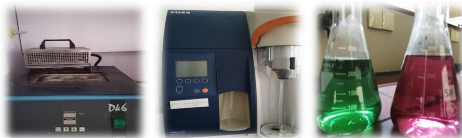
Εικόνα 2.3 Απεικόνιση συσκευής πέψης και απόσταξης για την ανάλυση της Kjeldahl, καθώς και τα διαλύματα πριν και μετά την τιτλοδότηση
