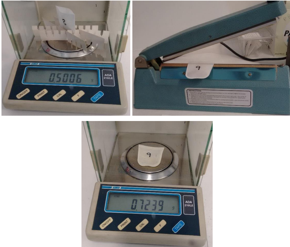
Εικόνα 18: Πάνω αριστερά ζύγιση 0.5 g δείγματος, δεξιά συγκόλληση σακιδίου, κάτω ζύγιση μικτού βάρους μετά από ανάλυση (εικόνα από προσωπικό αρχείο)
