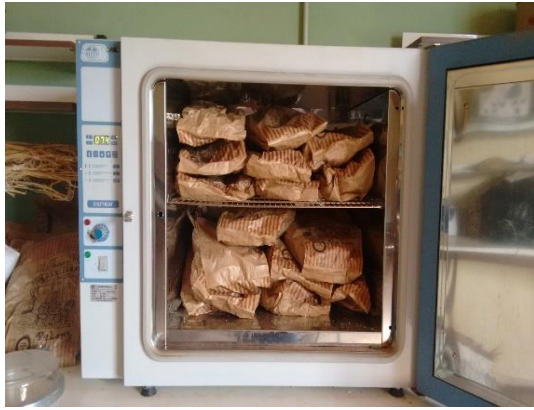
Εικόνα 11: Διαδικασία ξήρανσης φυτών σε κλίβανο και καταγραφής ξηρού βάρους (εικόνα από προσωπικό αρχείο)
