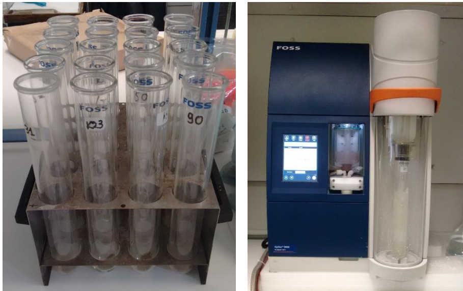
Εικόνα 16: Σωλήνες Kjeldahl και αυτόματη συσκευή Foss - Kjeltec 8400 (εικόνα από προσωπικό αρχείο)
