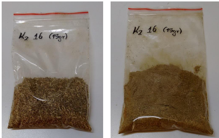
Εικόνα 13: Αποτέλεσμα της άλεσης των δυο μύλων, Η αριστερή εικόνα ανταποκρίνεται στον μύλο άλεσης του εργατηρίου εργαστηρίου Γεωργίας και η δεξιά σε αυτόν του Φυσιολογίας, Θρέψεως και Διατροφής που έδωσε και την τελική μορφή των δειγμάτων (εικόνα από προσωπικό αρχείο)
