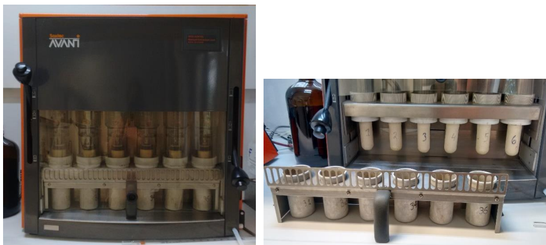
Εικόνα 17: Συσκευή εκχύλισης Soxhlet (Soxtec Avanti 2055), φυσίγγιο κυτταρίνης και ειδικό ποτήρι από αλουμίνιο (εικόνα από προσωπικό αρχείο)
