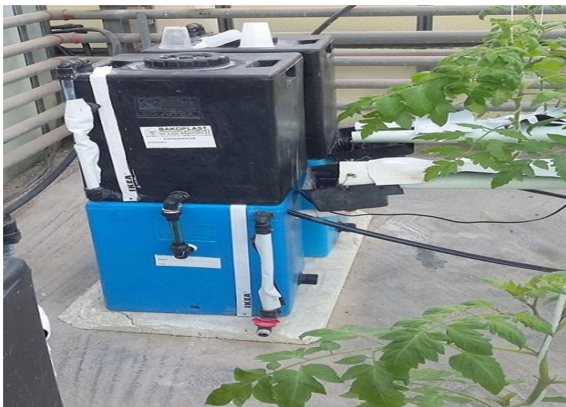
Εικόνα 2.1: Άποψη του κλειστού υδροπονικού συστήματος. Διακρίνονται οι δύο δεξαμενές παροχής Θ.Δ., το κανάλι NFT και οι ειδικούς συλλέκτες διαλύματος απορροής.
