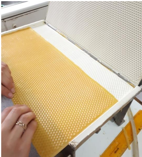
Εικόνα 2.2.7 Άνοιγμα πρέσσας και αφαίρεση έτοιμου φύλλου κηρήθρας.
