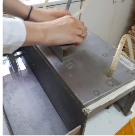
Εικόνα 2.2.6 Κλείσιμο πρέσσας προς σχηματισμό του φύλλου κηρήθρας.
