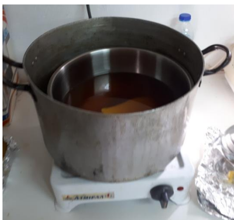
Εικόνα 2.2.3 Λιώσιμο του κεριού σε υδατόλουτρο (μπεν μαρί).
