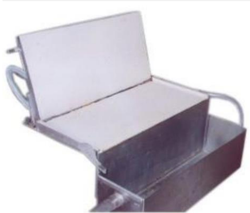
Εικόνα 2.2.2 Πρέσα παρασκευής φύλλων κηρήθρας.
