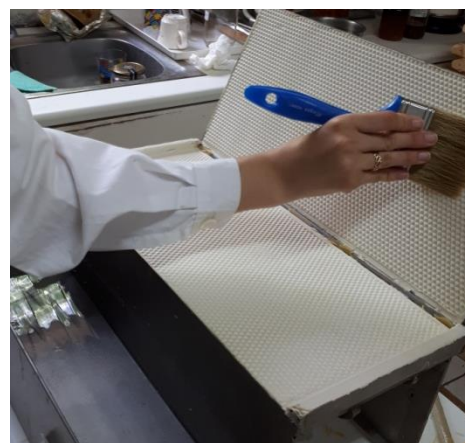
Εικόνα 2.2.4 Επάλειψη σιλικόνης με σαπουνόνερο.
