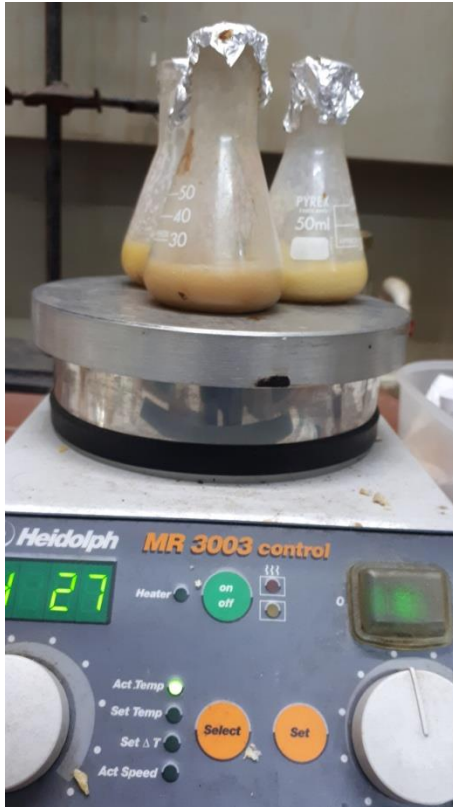
Εικόνα 2.4.4 Ανακίνηση δειγμάτων με μεταλλικό αναδευτήρα.
