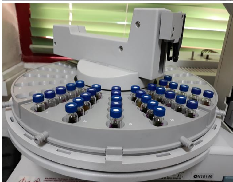
Εικόνα 14 Επάνω, αέριος χρωματογράφος GC/EI/MS (Agilent 6890 MS (Agilent Technologies Inc.), κάτω τα παραγωγγοποιημένα δείγματα τομάτας με αιθανολικά εκχυλίσματα με Αλόη, αιθανολικά και υδατικά διαλύματα (Μάρτυρες) έτοιμα προς ανάλυση
