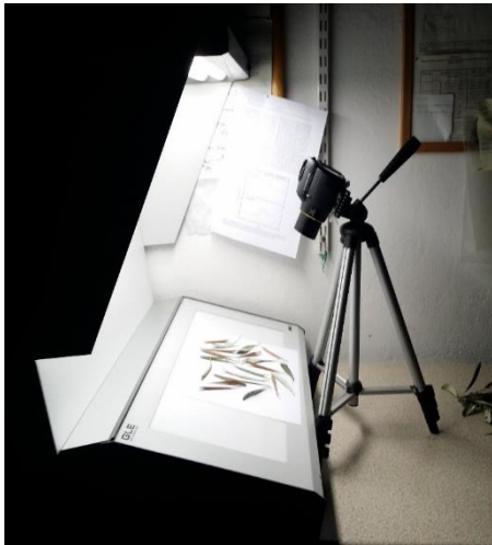
Εικόνα 3.12. Ο φωτογραφικός κλωβός ο οποίος χρησιμοποιήθηκε για την λήψη φωτογραφιών μολυσμένων κελυφωτών φιστικιών, σπόρων κριθαριού, σταφυλιών και φύλλων μελιτζάνας
