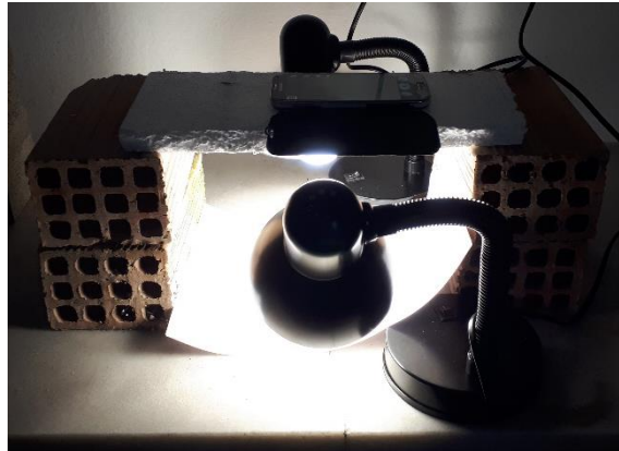
Εικόνα 3.13. Ο αυτοσχέδιος φωτογραφικός κλωβός ο οποίος χρησιμοποιήθηκε για την φωτογράφιση φύλλων ελιάς με συμπτώματα βερτισιλλίωσης
