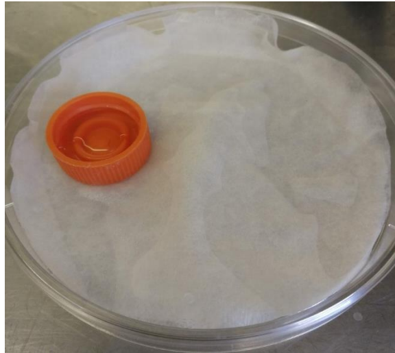
Εικόνα 3.6. Τρυβλίο με διπλό διηθητικό χαρτί στη βάση του και καπάκι από σωληνάριο τύπου falcon. Στο διηθητικό χαρτί προστέθηκε 1 ml νερού και στο καπάκι 2 ml νερού για διατήρηση συνθηκών υψηλής σχετικής υγρασίας, οι οποίες ευνοούν την ανάπτυξη των μυκήτων που χρησιμοποιήθηκαν για τις τεχνητές μολύνσεις
