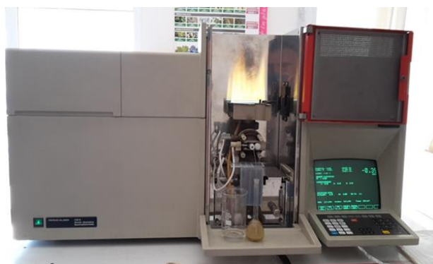
Εικόνα 45: Μέτρηση των στοιχείων στην ατομική απορρόφηση, σε φλόγα ακετυλενίου και αέρα.
