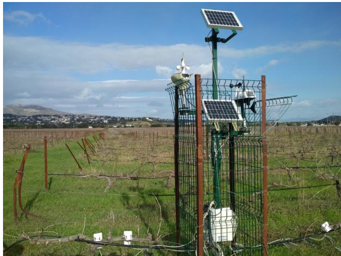
Εικόνα 60: Φωτογραφία του τηλεμετρικού σταθμού, εγκατεστημένου στον πειραματικό αμπελώνα του Γ.Π.Α, στα Σπάτα.
