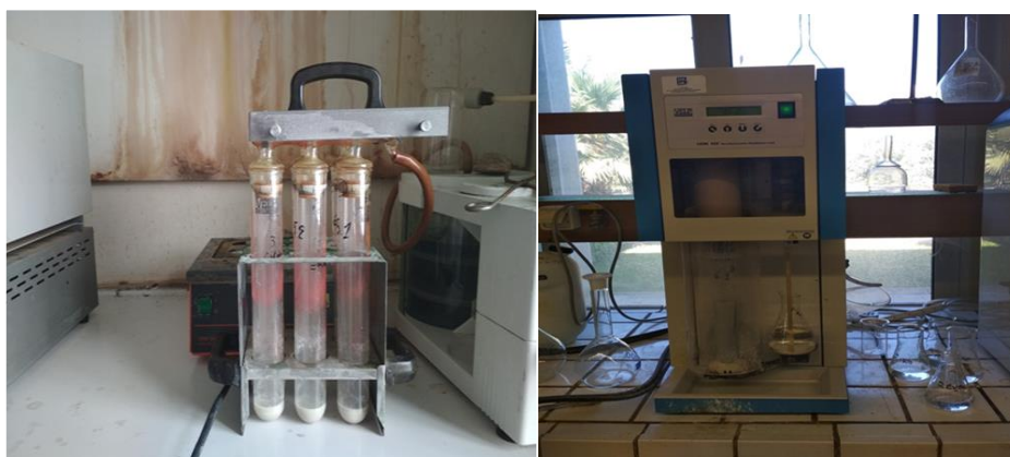
Εικόνες 42, 43: Καύση του δείγματος, Συσκευή Bucchi.
