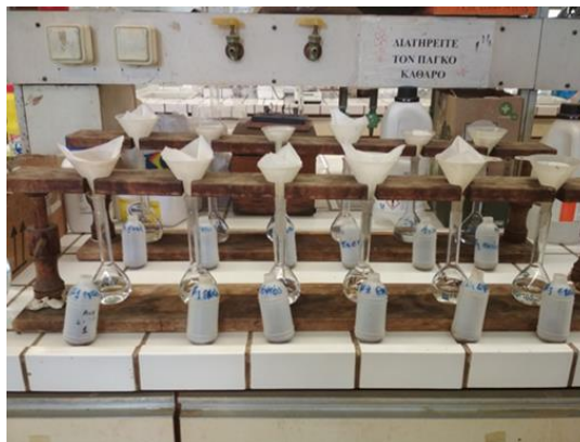
Εικόνα 40: Το υπερκείμενο διηθείται σε ογκομετρική φιάλη των 100 mL.
