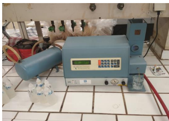
Εικόνα 41: Μέτρηση K και Na στο φλογοφωτόμετρο.
