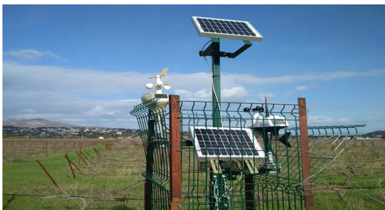
Εικόνα 10: Τηλεμετρικός σταθμός στον πειραματικό αμπελώνα των Σπάτων, Ιανουάριος 2018.
