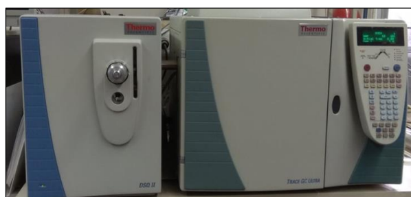
Εικόνα 1.16. Αέριος χρωματογράφος της εταιρίας THERMO GC ULTRA συζευγμένος με φασματόμετρο μαζών DSQ II.
