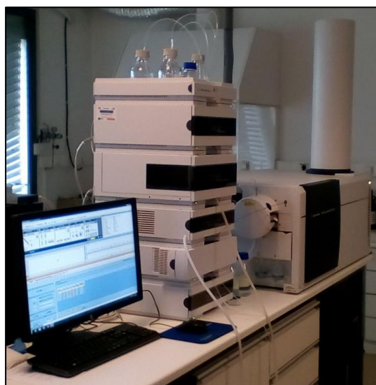
Εικόνα 1.17. Υγρός χρωματογράφος της εταιρίας Agilent Technologies της σειράς 1200 συζευγμένο με HRMS (Q-TOF) της σειράς 6530 Accurate-Mass.
