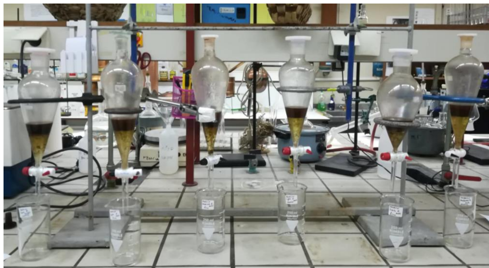
Εικόνα 25: Εκχύλιση καφεΐνης από διχλωρομεθάνιο με διαχωριστική χοάνη. Πηγή: Προσωπική συλλογή
