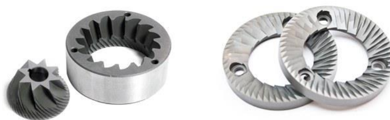
Εικόνα 17: Δεξιά επίπεδα μαχαίρια και αριστερά κωνικά μαχαίρια
