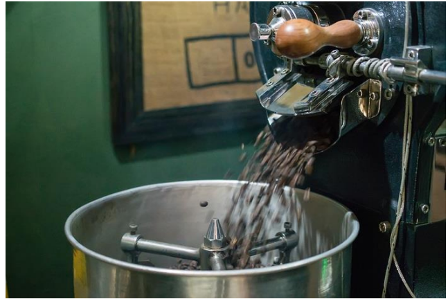
Εικόνα 14: Άμεση ψύξη καβουρδισμένων κόκκων καφέ Πηγή: https://www.google.com/search?biw=... (Βλ. Βιβλιογραφία)
