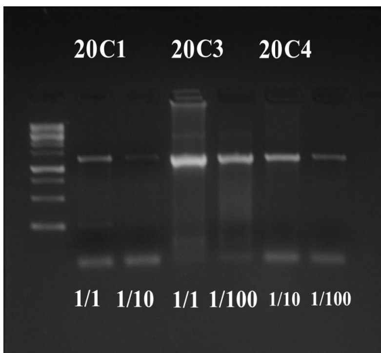
Εικόνα 3.12. Μέσω PCR πολλαπλασιασμός του γονιδίου COI – Δείγματα 20C1 ( O. centrina ), 20C3 ( M. mobular ), 20C4 ( O. centrina ). Αραιώσεις 1/1, 1/10 και 1/100 σε πήκτωμα αγαρόζης 1.8%.
