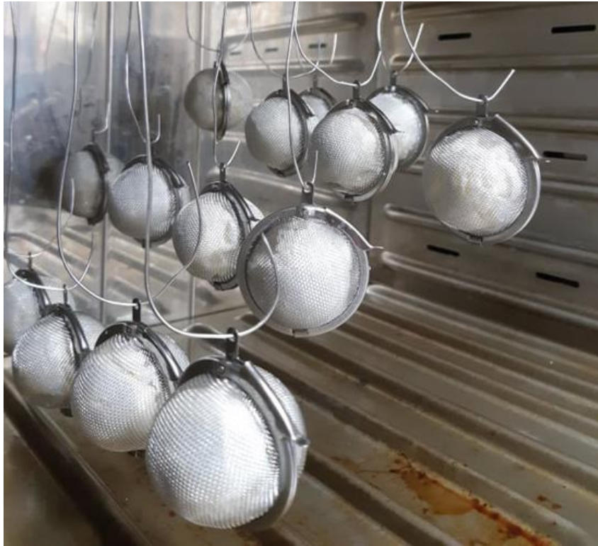
Σχήμα 7. Σφαιρικά δείγματα Ανθότυρου τοποθετημένα αιωρούμενα σε ξηραντήρα με ρεύμα αέρα (Memmert BE 400, Memmert GmbH + Co. KG, Schwabach, Germany).
