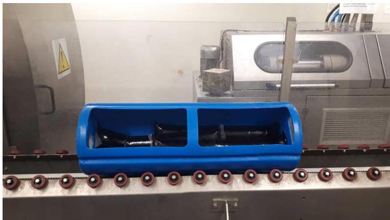
Εικόνα 11. Τα δείγματα οίνου συσκευασμένα σε περιέκτες πολυαιθυλενίου και μέσα στο δοχείο για το όργανο εφαρμογής HHP
