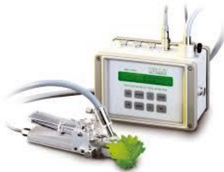
Εικόνα 9: Όργανο μέτρησης φθορισμού της χλωροφύλλης MINI-PAM Photosynthesis Yield Analyzer
