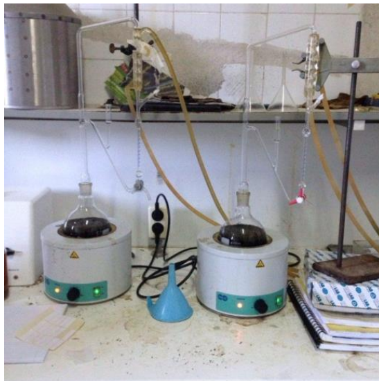
Εικόνα 15: Συσκευής απόσταξης τύπου Clevenger
