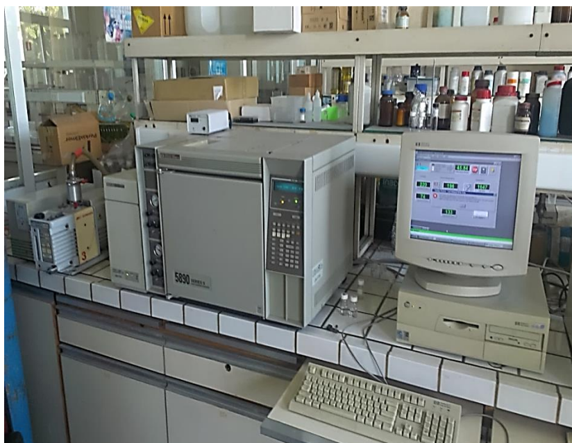
Εικόνα 16: : Σύστημα GC/MS του Εργαστηρίου Γενικής Χημείας του Γ.Π.Α. που χρησιμοποιήθηκε για την ποιοτική και ποσοτική ανάλυση των αιθέριων ελαίων.
