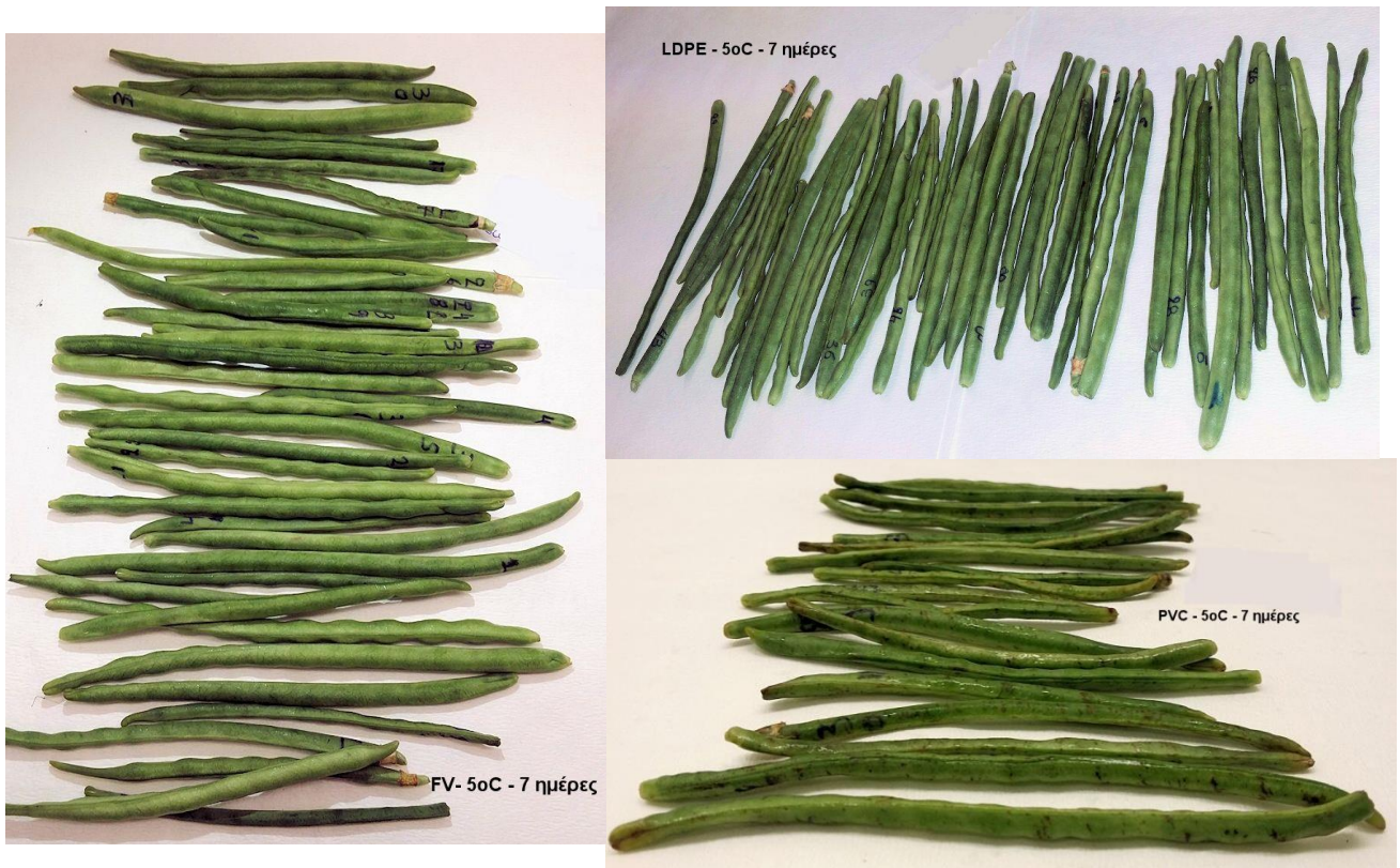
Εικόνα 3.2. Εμφάνιση λοβών βίγνας μετά τη συντήρησή τους για 7 ημέρες στους 5 °C σε πλαστικές συσκευασίες με φύλλα LDPE, FV, PVC.
