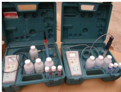
Εικόνα _10: Αριστερά φορητό πεχάμετρο και δεξιά φορητό αγωγιμόμετρο
