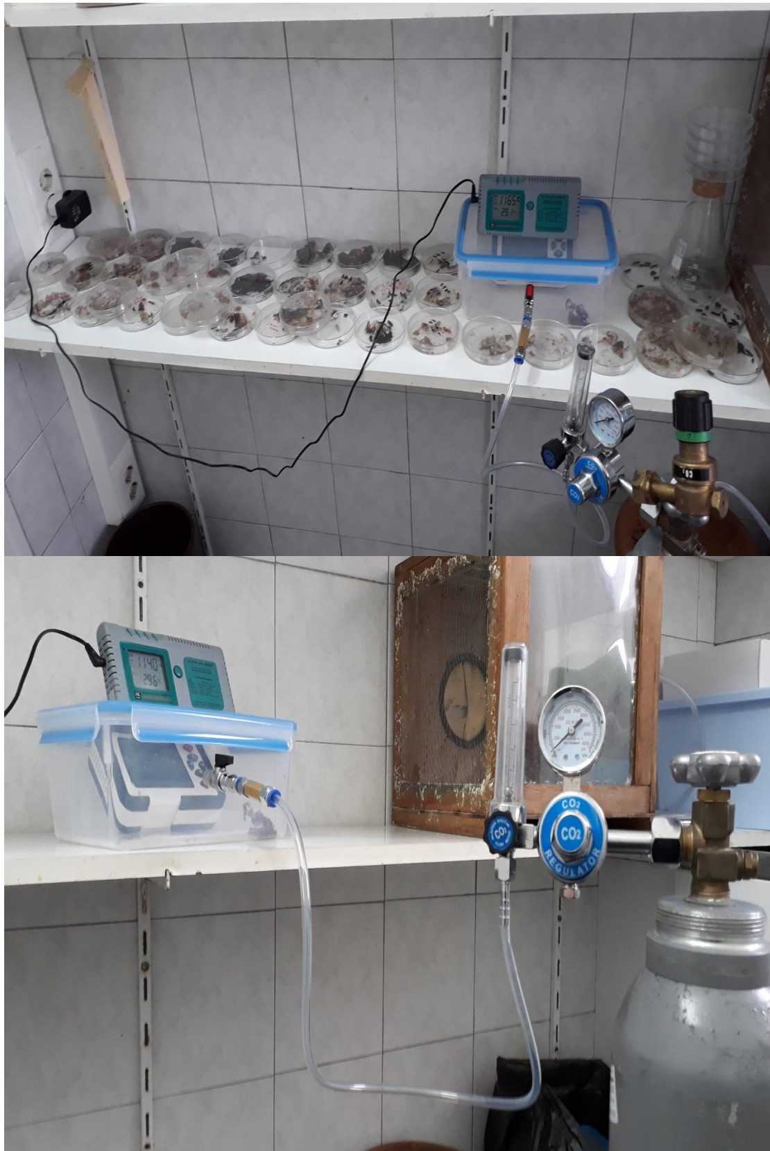
Εικόνα 20. Σύστημα εφαρμογής-μέτρησης CO 2 σε πλήρη λειτουργία (φιάλη).
