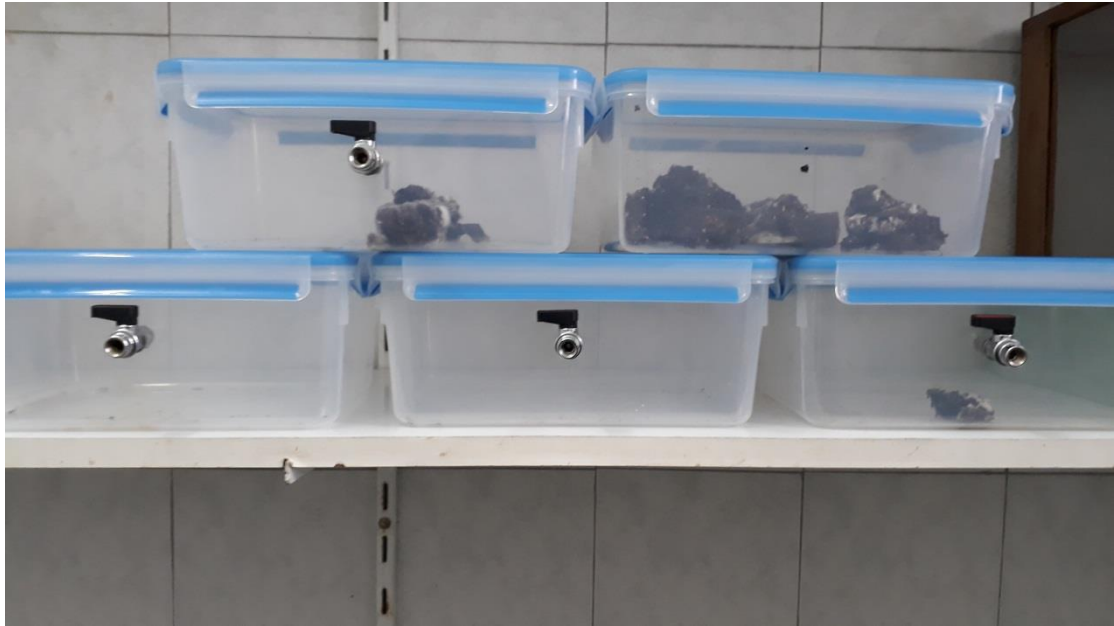
Εικόνα 12. Δοχεία με βαλβίδα εισόδου για εφαρμογή CO 2 και μάρτυρας .
