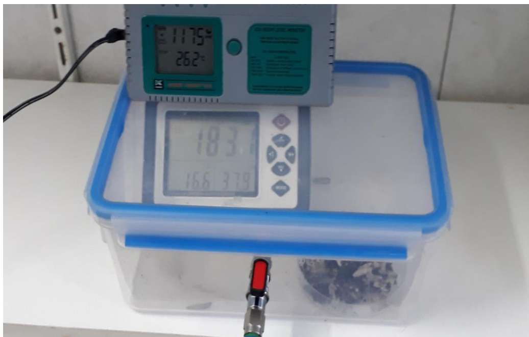
Εικόνα 16 .Μετρητές επιπέδων CO 2 εσωτερικού χώρου.
