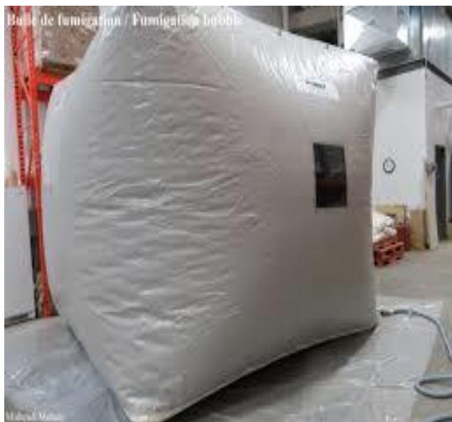
Εικόνα 9. Παράδειγμα κατασκευής απεντόμωσης με χρήση CO 2 . ( http://www.maheu-maheu.com )
