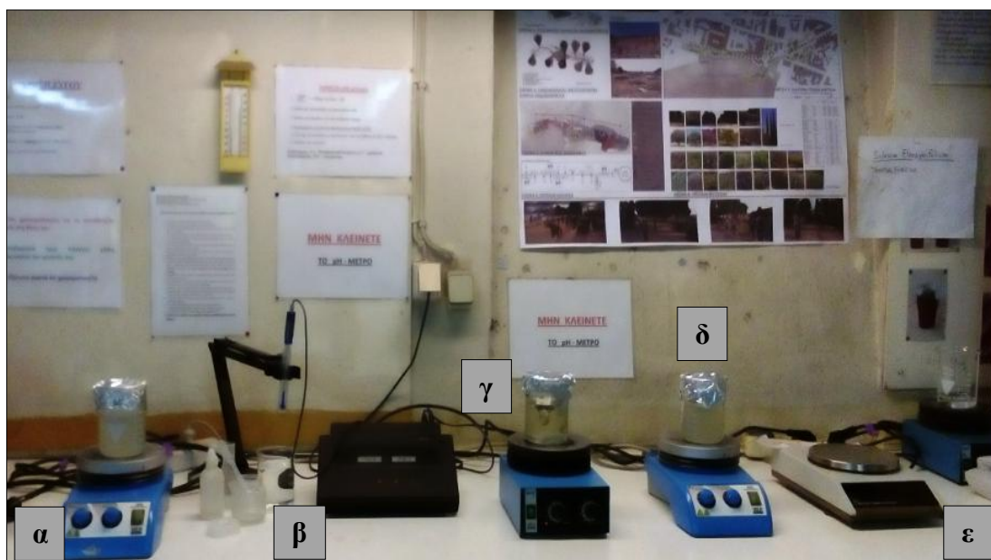
Εικόνα 25. (α) Αναδευτήρας, (β) Πεχάμετρο και διαλύματα ρύθμισης pH, δοχεία ζέσεως που περιέχουν θρεπτικό υπόστρωμα (γ) λίγο πριν γίνει διαυγές διάλυμα και (δ) αμέσως μετά την έναρξη της θέρμανσης, (ε) ζυγός.
