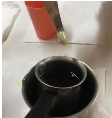
Εικόνα 2.2.3.4: Εμβάπτιση καλουπιού σε ζεστό κερί διαδοχικά για 3-4 φορές
