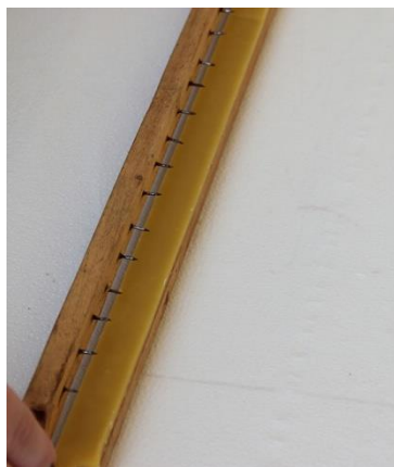
2.1.4.4: Σχηματισμός θέσεων στον πήχη με επιστρωμένο κερί
