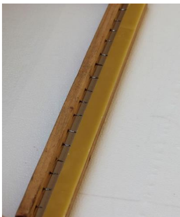
2.1.4.1: Σχηματισμός θέσεων στον πήχη με επιστρωμένο κερί
