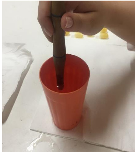
Εικόνα 2.2.3.2: Εμβάπτιση καλουπιού σε κρύο νερό
