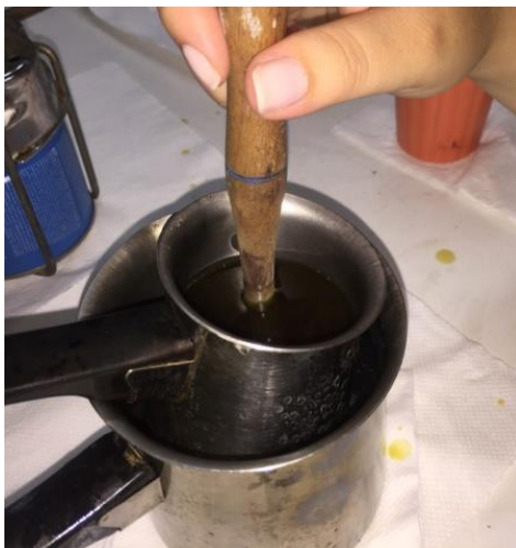
Εικόνα 2.2.3.3: Εμβάπτιση καλουπιού σε ζεστό κερί
