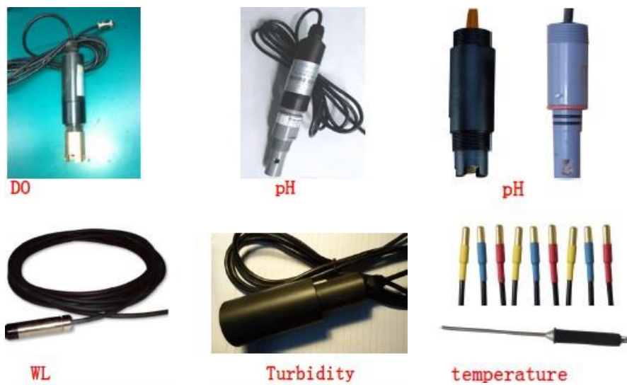
Εικόνα 3.6: Διάφοροι αισθητήρες δεύτερης γενιάς (Πηγή: Internet of Things in Aquaculture. Li, D.)
