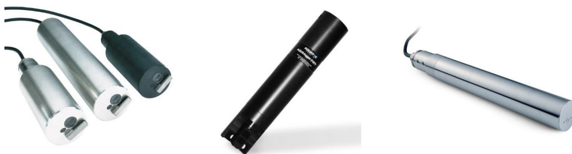
Εικόνα 3.4: Διάφοροι αισθητήρες μέτρησης της θολότητας (Πηγές: www.hach.com , www.aquatecgroup.com )
