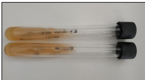
Εικόνα 12. Κεκλιμένοι σωλήνες (slants) πληρωμένοι με θρεπτικό μέσο YPDA
