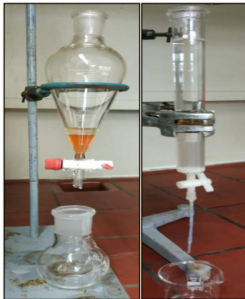
Εικόνα 17. Διαχωρισμός για τη παραλαβή του καθαρού λίπους (αριστερά) & στήλη κλασμάτωσης (δεξιά)
