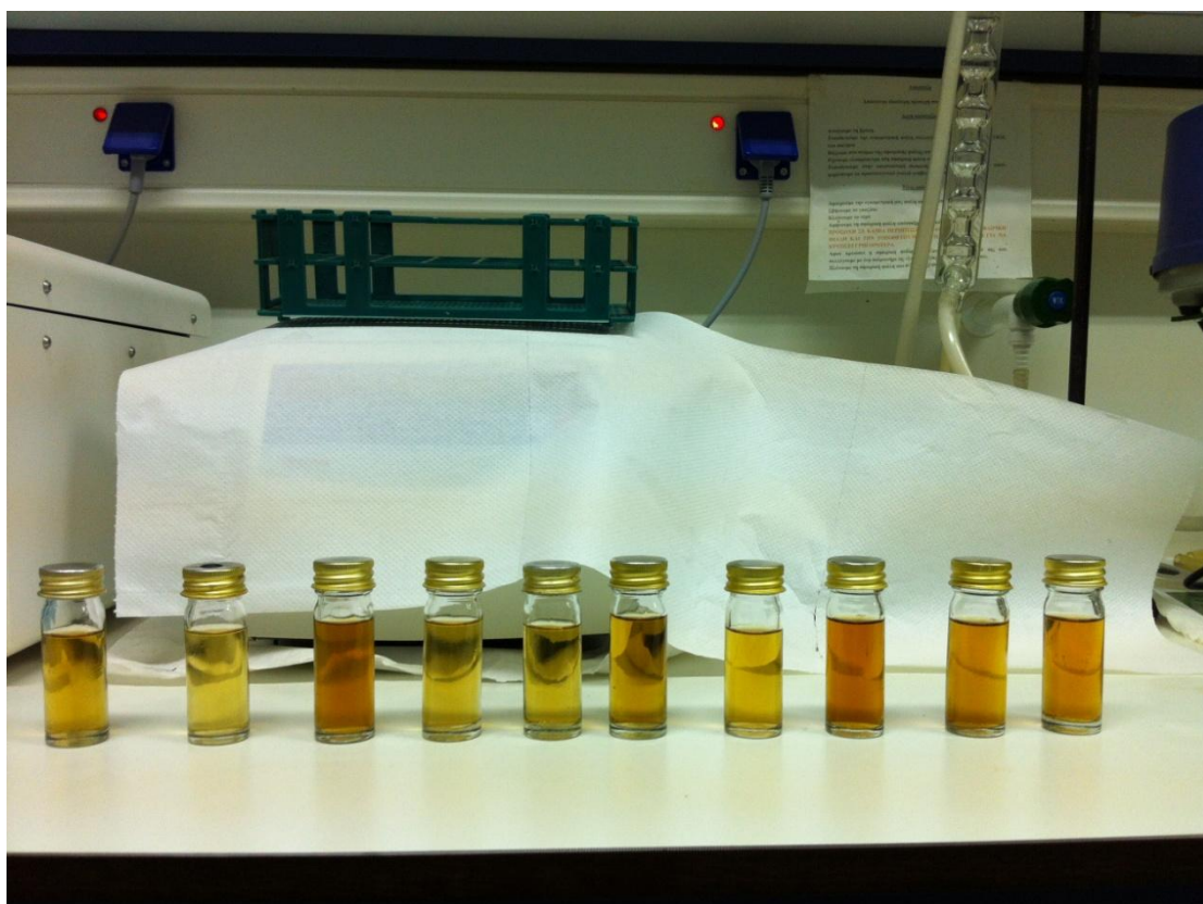
Εικόνα 18. Φωτογραφία με τα vials που περιέχουν τους οίνους οι οποίοι υποβάλλονται σε συνθήκες επιταχυνόμενης οξείδωσης
