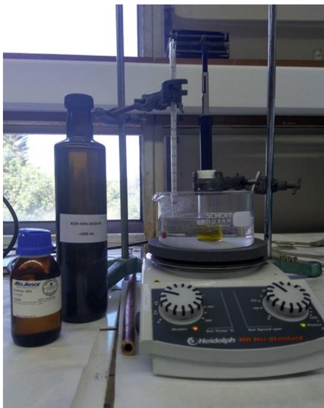
Εικόνα Β.1.1: Διαδικασία εκχύλισης πτητικών συστατικών από τα δείγματα ελαιολάδου με την τεχνική SPME.
