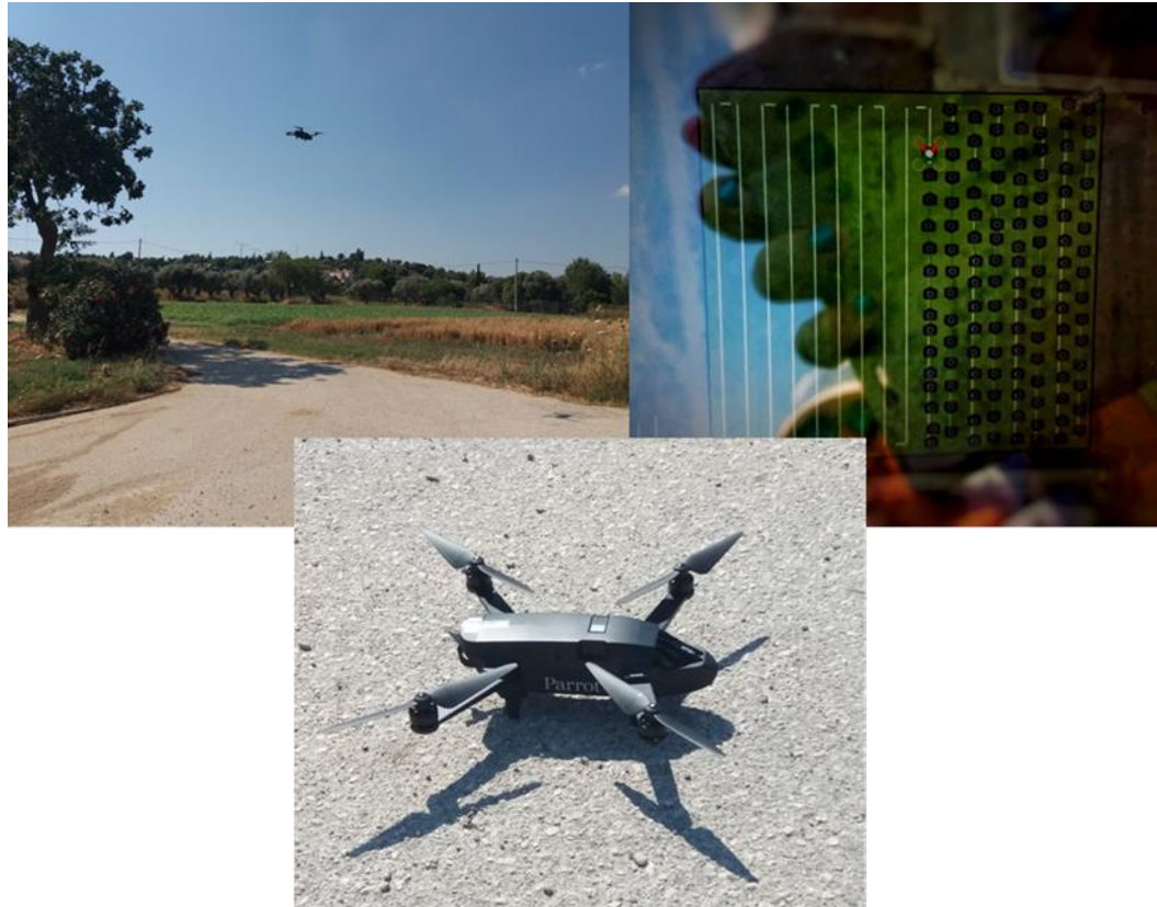
Εικόνα 18: UAV εξοπλισμένο με πολυφασματικό αισθητήρα Parrot Sequoia (a) και φωτογραφία κατά την πτήση του UAV σύμφωνα με το προκαθορισμένο σχέδιο πτήσης στον αγρό ενδιαφέροντος στο αγρόκτημα του Γεωπονικού Πανεπιστημίου Αθηνών στα Σπάτα Αττικής.
