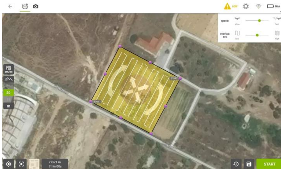
Εικόνα 20: Απεικόνιση του σχεδίου πτήσης στο λογισμικό Pix4D Capture στον αγρό ενδιαφέροντος στα Σπάτα Αττικής.
